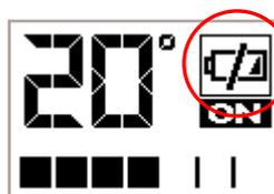
Dès que le niveau des piles ne permet en aucun cas la communication radio, télécommande montre, sur tout l'écran, l'image de la pile déchargée et il bloque toutes les fonctions qui lui sont liées jusqu'à remplacement advenu des piles.
