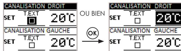
Pression des touches **↑** **↓** pour activer/désactiver le flag si on souhaite gérer la température de la zone à canaliser à l'aide d'un thermostat externe (non fourni). Touche **OK** pour confirmation.
